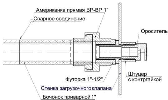
Рисунок 3 – Монтаж оросителя.
